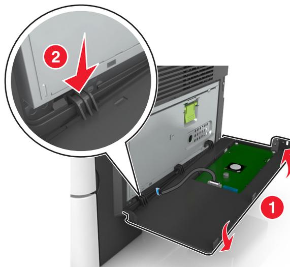
**10** Lassen Sie den übrigen Teil der Abdeckung herunter und schieben Sie die Abdeckung nach rechts.
