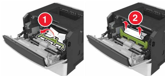
**5** Setzen Sie die Belichtungseinheit ein.
