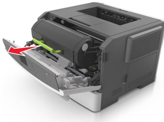
**3** Entfernen Sie die Belichtungseinheit.
